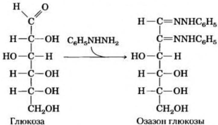
Температуру плавления этих веществ легко определяют и используют для характеристики каждого из них. Это свойство использовали при идентификации моносахаридов до появления высокоэффективной жидкостной хроматографии (ВЭЖХ) и
