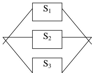
каждый из них может выйти из строя с вероятностью  $p$ . Функционирование схемы нарушается, если все они выходят из строя. Тогда вероятность правильной работы устройства равна...
