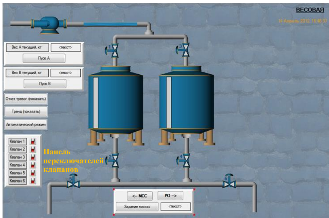
Рис. 14. Основной экран при работе в ручном режиме
