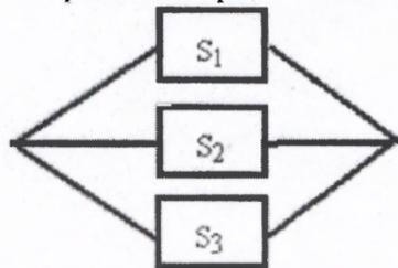
каждый из них может выйти из строя с вероятностью  $p$ . Функционирование схемы нарушается, если все они выходят из строя. Тогда вероятность правильной работы устройства равна...
